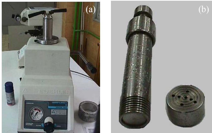
Figura 3.1. Prensa para la conformación de las briquetas (a) y dispositivo manual para la conformación de los pellets (b).
